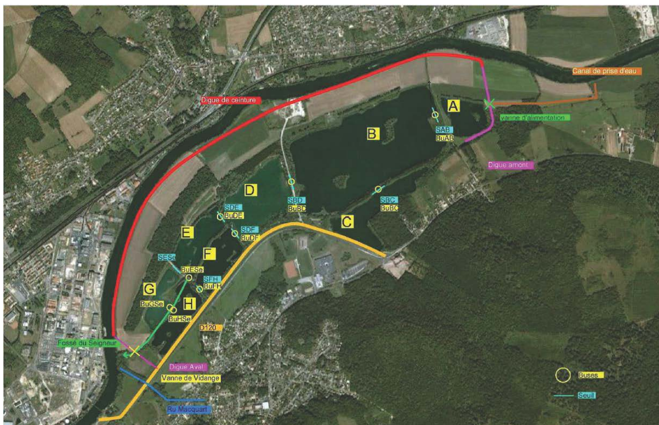
Figure 3 : Principe d'aménagement du site d'écrêtement de crues de Verneuil-en-Halatte
